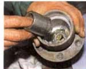
Das äußere Lager sitzt tief im Radträger. Zur Montage suchten wir uns deshalb einen alten Bremskolben passenden Durchmessers und ein Stück Rohr als Hilfswerkzeuge. Beim Einschlagen des Lagers darf nur dessen äußerer Ring belastet werden. Es folgt die Distanzhülse – die gar nicht selten vergessen wird...
