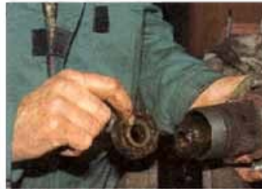
Zwischen den Lagern ist eine Distanzhülse montiert, die hier noch in der Nabe zu sehen ist
