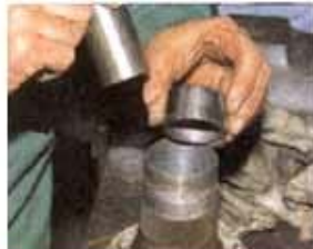
Das äußere Lager sitzt tief im Radträger. Zur Montage suchten wir uns deshalb einen alten Bremskolben passenden Durchmessers und ein Stück Rohr als Hilfswerkzeuge. Beim Einschlagen des Lagers darf nur dessen äußerer Ring belastet werden. Es folgt die Distanzhülse – die gar nicht selten vergessen wird...
