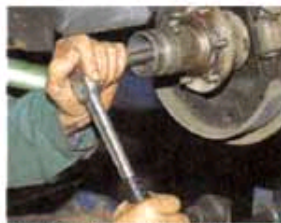
So bitte auf keinen Fall: Wenn sich die Nabe nicht problemlos auf den Achsstummel schieben lässt, sollte mit Hilfe eines Rohrs und eines Hammers Kraft auf den inneren Lagerring ausgeübt werden. Die Haltemutter zieht alles in seine korrekte Position. Das Spiel muss nicht eingestellt werden, ein neuer Splint noch – fertig
