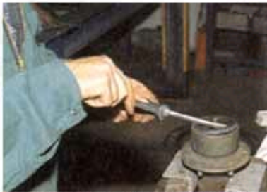
Der Simmerring dichtet die MG-Radnabe nach innen ab und muss erneuert werden
