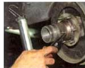
So bitte auf keinen Fall: Wenn sich die Nabe nicht problemlos auf den Achsstummel schieben lässt, sollte mit Hilfe eines Rohrs und eines Hammers Kraft auf den inneren Lagerring ausgeübt werden. Die Haltemutter zieht alles in seine korrekte Position. Das Spiel muss nicht eingestellt werden, ein neuer Splint noch – fertig
