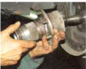
So bitte auf keinen Fall: Wenn sich die Nabe nicht problemlos auf den Achsstummel schieben lässt, sollte mit Hilfe eines Rohrs und eines Hammers Kraft auf den inneren Lagerring ausgeübt werden. Die Haltemutter zieht alles in seine korrekte Position. Das Spiel muss nicht eingestellt werden, ein neuer Splint noch – fertig
