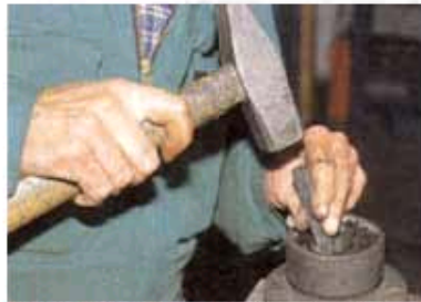
Auch die Rillenkugellager werden mit einem langen Dorn ausgeschlagen
