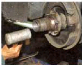
So bitte auf keinen Fall: Wenn sich die Nabe nicht problemlos auf den Achsstummel schieben lässt, sollte mit Hilfe eines Rohrs und eines Hammers Kraft auf den inneren Lagerring ausgeübt werden. Die Haltemutter zieht alles in seine korrekte Position. Das Spiel muss nicht eingestellt werden, ein neuer Splint noch – fertig
