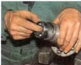
Das äußere Lager sitzt tief im Radträger. Zur Montage suchten wir uns deshalb einen alten Bremskolben passenden Durchmessers und ein Stück Rohr als Hilfswerkzeuge. Beim Einschlagen des Lagers darf nur dessen äußerer Ring belastet werden. Es folgt die Distanzhülse – die gar nicht selten vergessen wird...
