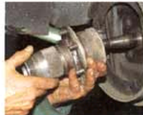
Das äußere Lager sitzt tief im Radträger. Zur Montage suchten wir uns deshalb einen alten Bremskolben passenden Durchmessers und ein Stück Rohr als Hilfswerkzeuge. Beim Einschlagen des Lagers darf nur dessen äußerer Ring belastet werden. Es folgt die Distanzhülse – die gar nicht selten vergessen wird...
