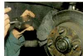
Nach der Demontage des Rads wird die Fettkappe entfernt. Unter ihr verbirgt sich die durch einen Splint gesicherte Kronenmutter. Der Bremsattel wird demontiert (zumindest über seine Kolben zurückgesetzt), um das Laufgeräusch der Lager korrekt einschätzen zu können. Wir zogen die Mutter mit dem werkseitig vorgegebenen Drehmoment an. Das Lagerspiel war anschließend korrekt, die Laufgeräusche blieben jedoch. Einzige Lösung: Radlager austauschen
