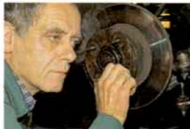
Nach der Demontage des Rads wird die Fettkappe entfernt. Unter ihr verbirgt sich die durch einen Splint gesicherte Kronenmutter. Der Bremsattel wird demontiert (zumindest über seine Kolben zurückgesetzt), um das Laufgeräusch der Lager korrekt einschätzen zu können. Wir zogen die Mutter mit dem werkseitig vorgegebenen Drehmoment an. Das Lagerspiel war anschließend korrekt, die Laufgeräusche blieben jedoch. Einzige Lösung: Radlager austauschen
