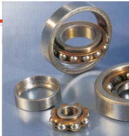
▶ Internationale Palette: Lager für das Antriebskegelrad einer frühen Lambretta, Lager für Zündmagneten von Scintilla und Marelli, Kurbelwellenlager für BSA M 20 sowie für Triumph und Adler
