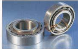
◀ Kurbelwellenlager für Zündapp: rechts für K 500 aus Altbestand, links für KS 750 modifiziert
